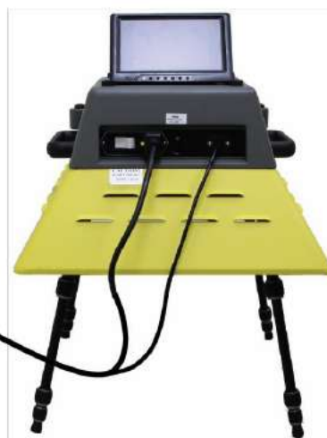
Рис. 2 – Система активной термографии NDTherm ® : а) блок обработки и анализа изображений; б) блок нагрева и регистрации динамики температуры
