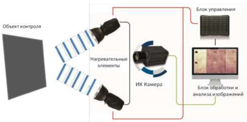
Рис. 1 – Схема контроля методом активной термографии
