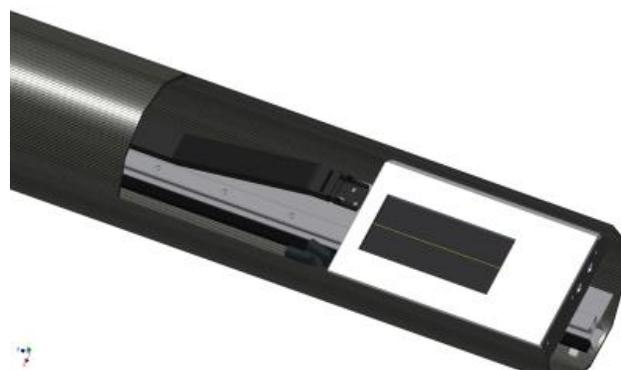
Рис.4.3 Сечение, показывающее расположение детектора внутри штанги.
