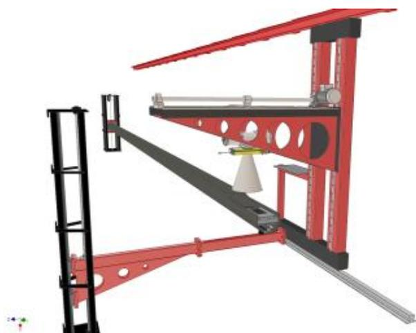
Рис 4.2 Новая система с углеволоконной штангой
