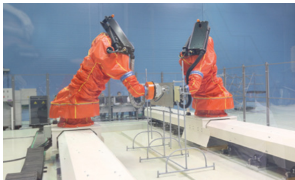
Рисунок 8. Ультразвуковая система контроля с использованием двух роботов на направляющих, с применением УЗК электроники на ФР (КАПО-Композит)
