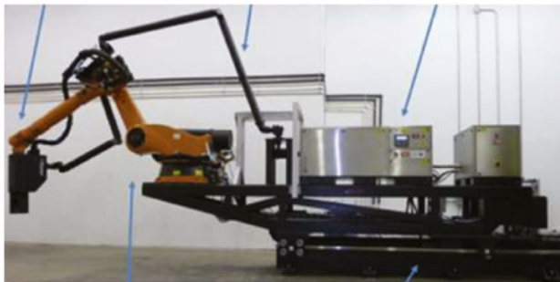
Рисунок 4. Конфигурация оборудования для метода ультразвукового контроля композиционных материалов на базе лазерного возбуждения
