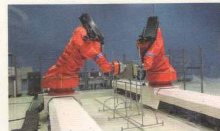
Рис. 3. Полностью автоматизированная роботизированная система ультразвукового контроля компании Tecnatom, установленная на Казанском предприятии КАПО-Композит
