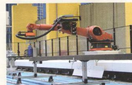
Рис. 4. Полностью автоматизированная роботизированная система ультразвукового контроля компании Tecnatom, установленная на Ульяновском предприятии Аэрокомпозит
