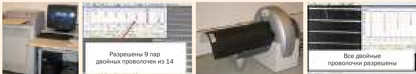
Рис. 8. Примеры КР систем и их измеренные базовые пространственные разрешения: слева – Dynamix XG-1 Fujifilm, SR_b = 130 мкм для стандартной КР-системы с ограниченным пространственным разрешением (толстая IP, высокая скорость, IP в жесткой cassette, автоматизированная загрузка, размер пикселя 100μ); справа – система высокого разрешения HD-CR 35 NDT, Dürr, SR_b = 40 мкм (ручная загрузка ЗП, разрешение 12μ, тонкая, голубая HD-IP)
