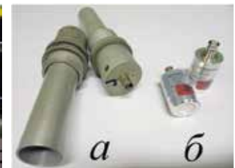
Рис. 4. Бесконтактные ПЭП: а — 40 кГц фирмы «Кропус»; б — 0,5 МГц фирмы «The Ultran Group», тип NCG500-D13 (США) [8]
